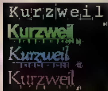
Fig. 4 - Classe fixe (a) ou variable (b, c, d). Pour l'homme, les textes écrits en classe variable (imprimerie) sont plus agréables à lire qu'en classe fixe (situation à éviter). En revanche, la lecture optique est plus simple pour des espacements fixes, car elle facilite le repérage des caractères.
